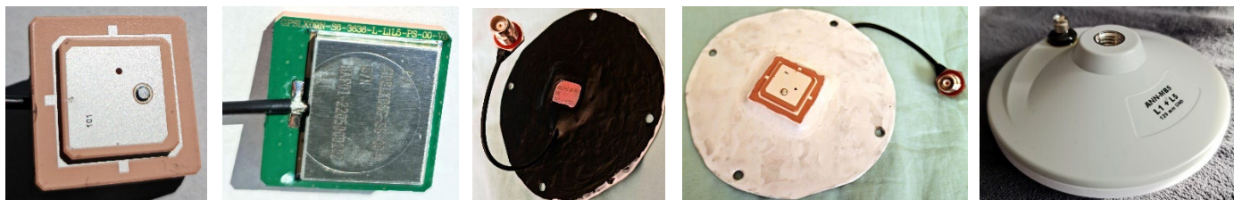
Metamorphose des Innenlebens einer ANN-MB5 mit 125-mm-Grundplatte in ein „UFO“-Antennengehäuse
