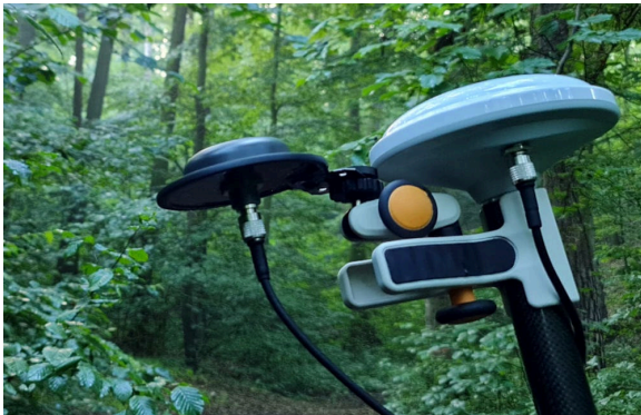
Parallele Messanordnung von TW3882 und TW1825 (jeweils mit erweiterter Grundplatte) auf einem gemeinsamen Stab
