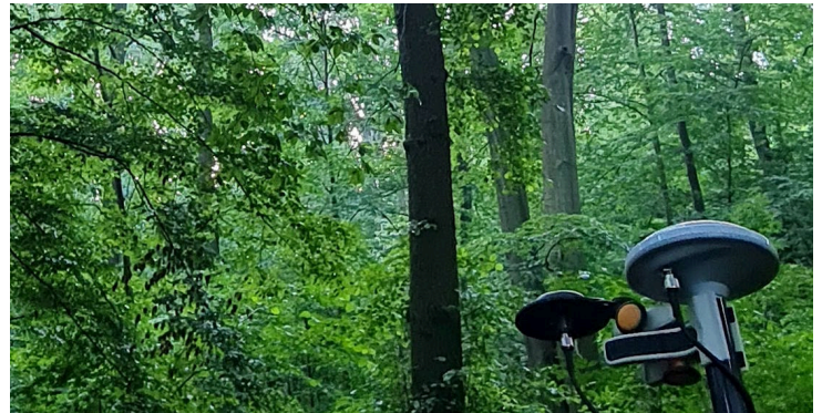
Parallele Messanordnung von TW3882 und TW1825 (jeweils mit erweiterter Grundplatte) auf einem gemeinsamen Stab
